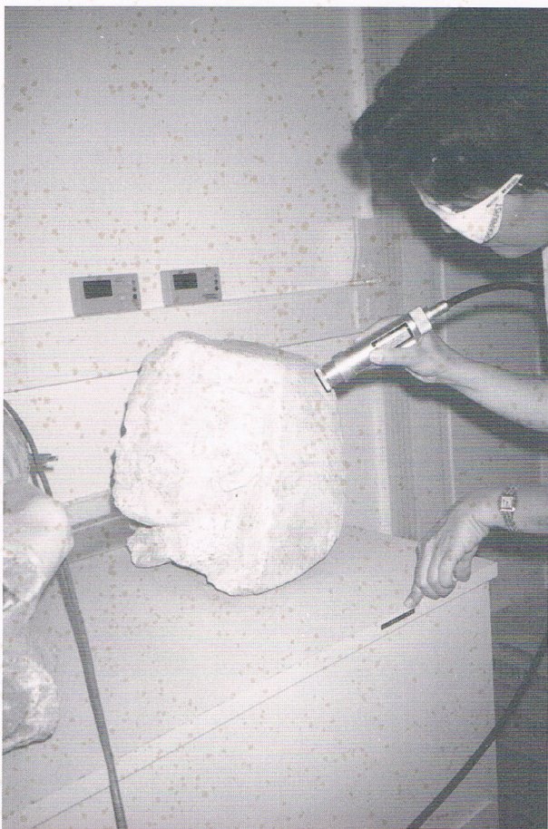
Nettoyage au laser d'une tête en marbre
